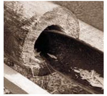
Tüchel (Wasserleitungsrohr aus Holz)
